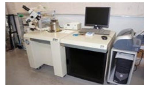
⑥AFM (原子間力顕微鏡) 日本電子 JSPM-5200
