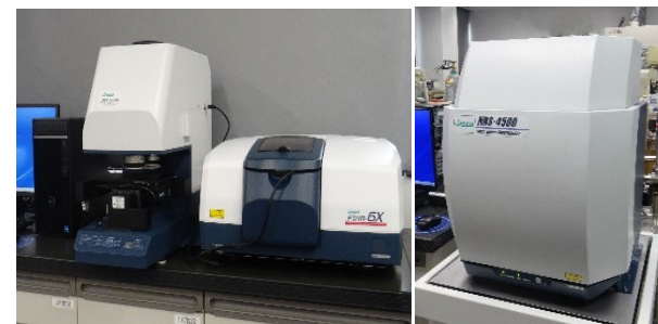
③FT-IR・Raman (フーリエ変換赤外分光光度計・ラマン分光 光度計) 日本分光 FT/IR-6X、NRS-4500
