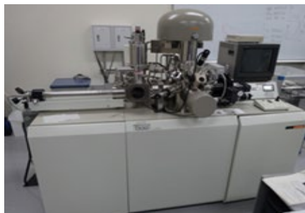
②XPS (X線光電子分光器) 日本電子 JPS-9010MC
