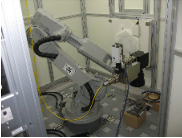
図3、定置式レーザー除染機と類似の機能を持つレーザー加工装置の例。
