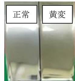
図1 スズ表面の黄変
