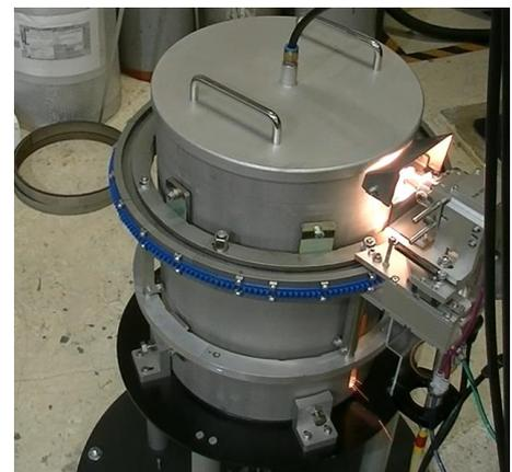
図1 改良したレーザー切断機材を用いて300A配管を切断する様子
