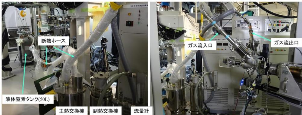
図1 液体窒素による冷却システムの様子
