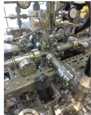
図 1 トリチウムイオン照射装置
