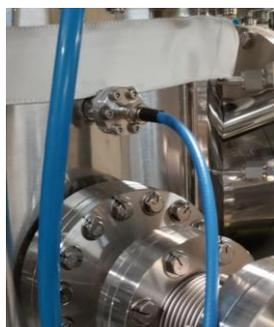
図3 マイクロ波イオン源イオン注入装置の照射チャンバにおける試料電流信号の取出し配線。
