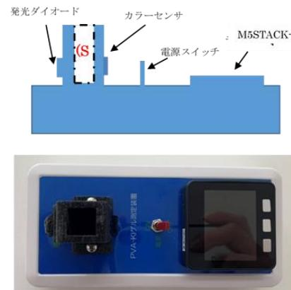
図1 in-situ 測定装置の概要及び写真
