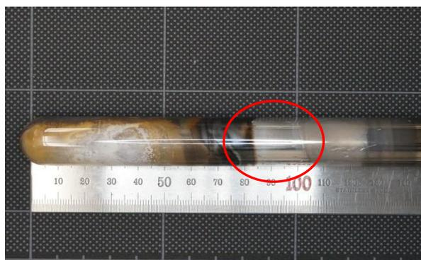
図3 内側石英管のみでの加熱で生じたマグネシウム(赤丸部)
