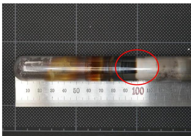
図6 熱浴への加熱で生じたマグネシウム(赤丸部)
