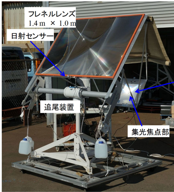
図1 自動追尾機構付き太陽炉
