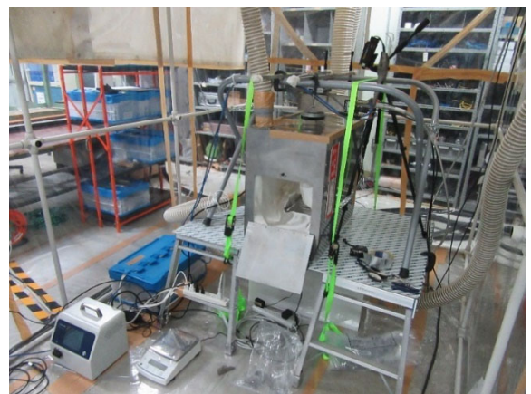
図 1 レーザー除染システムの外観
