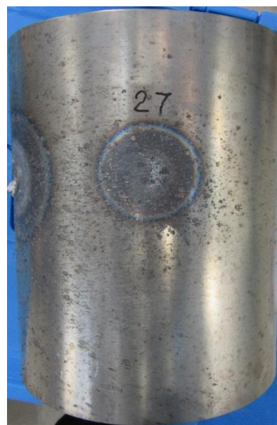
図 3 後方構造物の熱影響の様子
