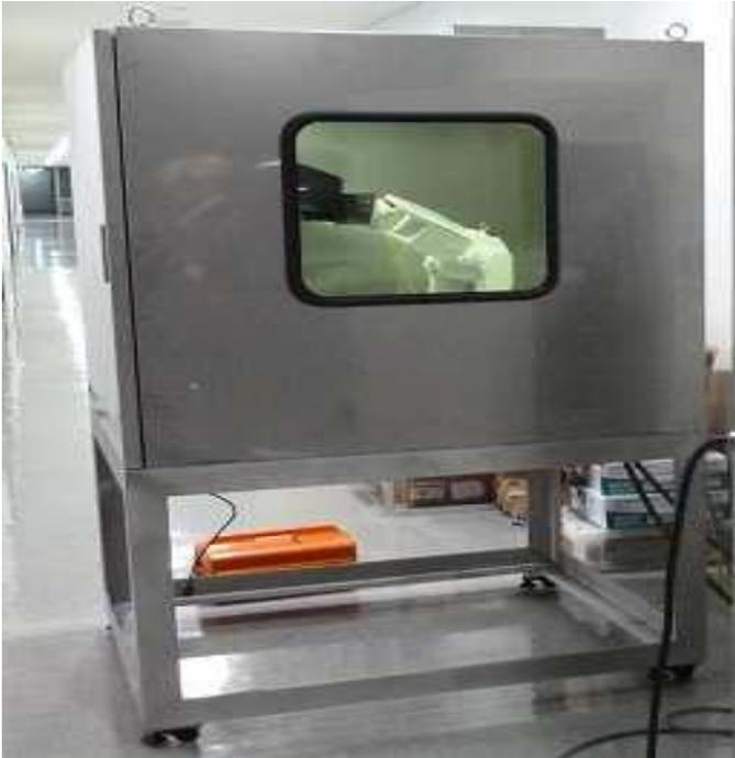
図 2 レーザー剥離用の作業箱。
