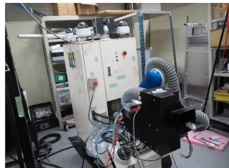
図1 開発されたレーザー剥離機をロボットアームに積載したクローラーの CAD 図(左図)と写真(右図)。
