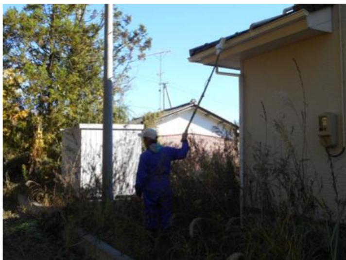
図4 帰還困難区域でのTCS-171改運用状況の例。手元において雨樋の迅速な計測が可能である。
