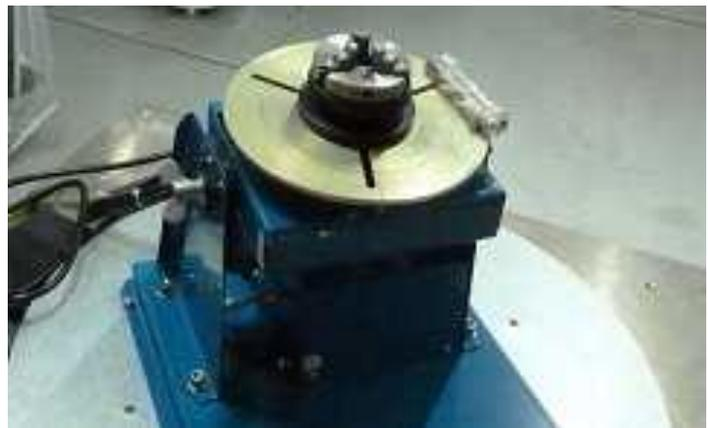
図 5 ポジショナー回転調節機構。
