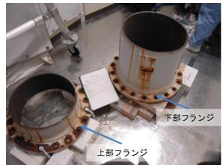
図 1 海水配管の切断
