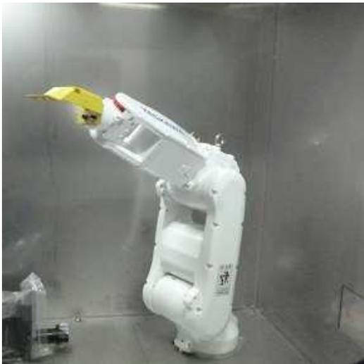
図 4 ロボットアーム安川電機製 MH5F。
