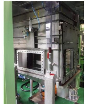
図 1 水中切断試験用水槽
