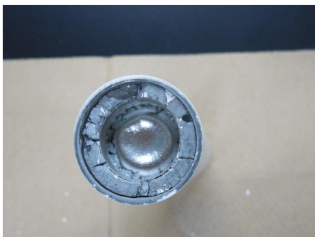
図1 熔融-凝固させたステンレス鋼原料。中央の光沢のある不部分がステンレス鋼、その外側の灰色の部分マグネシア粉末、その外側がアルミなるつばである。
