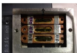
図 4 サンプル充填セル
