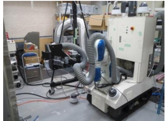
図1 レーザー剥離機をアームに積載した移動用クローラー写真
