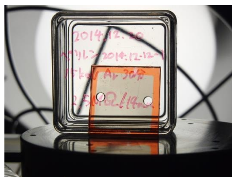
図1 ペリレン 3,4,9,10 テトラカルボン酸二無水物を蒸着後 Ar イオンを照射したポリカーボネート板。
