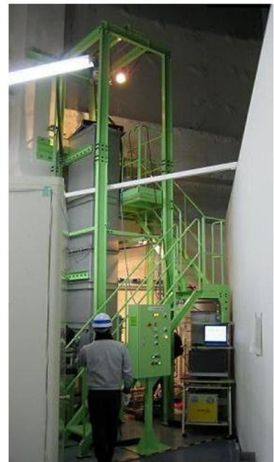
図 1 水中試験水槽本体と架台
