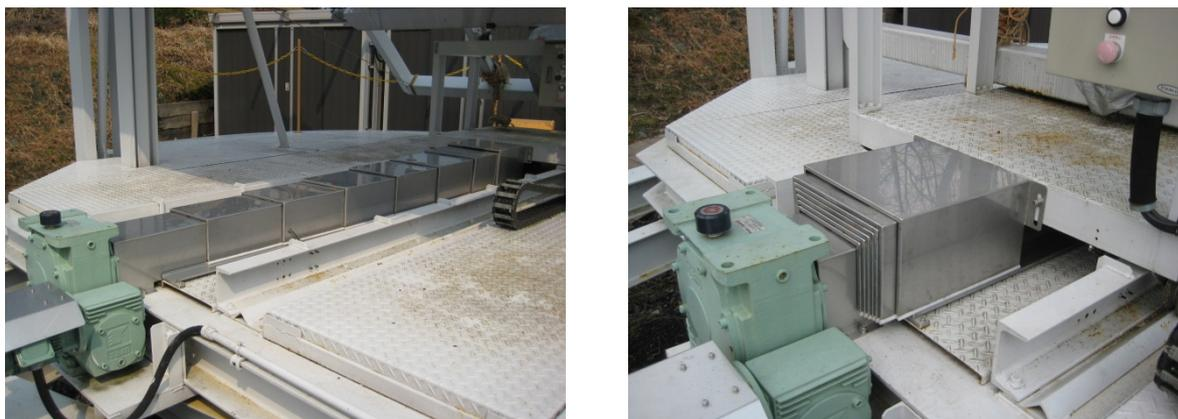
図 2 ジャバラ型ボールねじカバー 伸長時(左図)と縮小時(右図)
