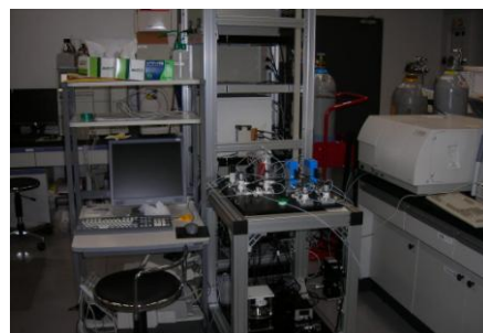
図2 雰囲気制御下蛍光スペクトル無人測定システム全景
