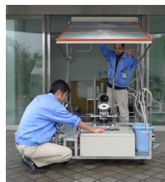
図-2 太陽熱駆動スターリングエンジン 発電システム(200W 発電)試作機
