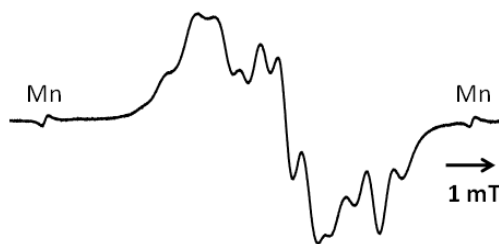
図-2 有機カルシウム塩に 20kGy の \gamma 線を照射した試料から得られた ESR 信号
