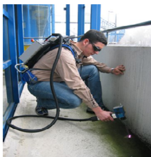
図1、小型レーザー除染装置の概念的利用説明図
