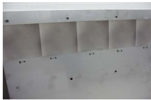
図2、ステンレス板、上部はレーザー剥離した部分
