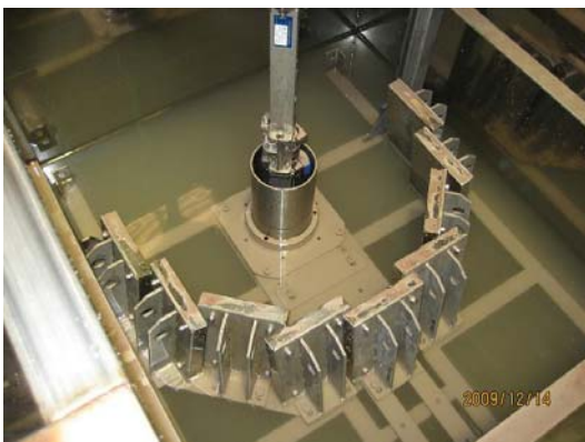
図-1 水中 AWJ 切断試験直後の様子 (カランドリア管、一部水抜き後、 周囲は“防護板”)
