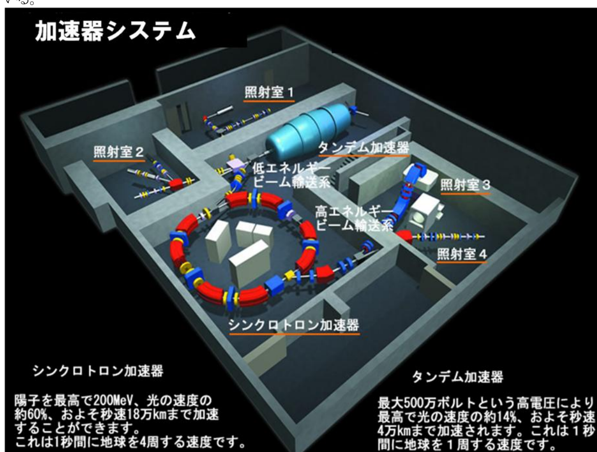
図1、若狭湾エネルギー研究センターの加速器システム鳥瞰図。
