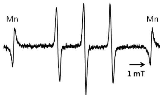
図-3 捕捉剤に 4-oxo-TEMP を使用して得た一重項酸素の存在を表す ESR 信号
