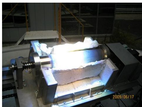
図-2 加熱中の回転式サガー
