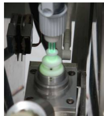
図 電子スピン共鳴装置を用いた光反応測定
