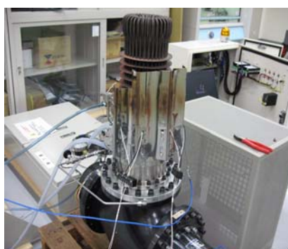
図1、試作した 600W集光球面ミラー。 図2、左は、停止中、右は動作中のスターリングエンジン発電機。
