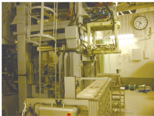
図1 改造後の陽子線がん治療研究装置外観。陽子線は2方向から輸送されます。
