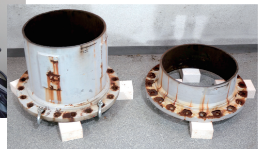
切断配管 [直径650mm]
