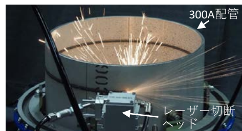
配管自動切断システムの試作
