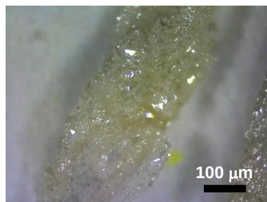
高温加熱後の \text{CeO}_2 粉末の光学顕微鏡像 結晶化して光沢を呈している
