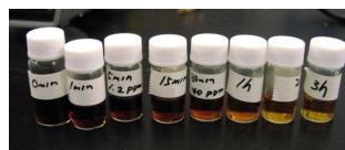
木質バイオマスに酵素を加えて反応させる実験と、分解・抽出した反応溶液
