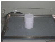
マイクロ波合成反応装置 で110℃1時間加熱
