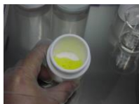
テフロン分解容器に 鏽と高純度塩酸、高純度硝酸を加える
