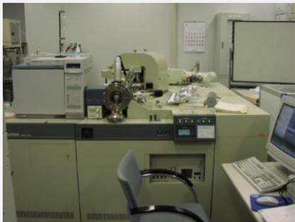
【特徴】有機化合物が含まれるガスを、物質ごとに分離してそれぞれの質量を精密に測定することで、含まれる有機化合物の種類とその量を高精度で分析する装置
