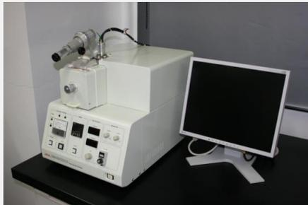
【特徴】電子顕微鏡観察用の断面試料を作製する装置。
