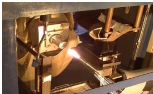
ステンレス鋼切断試験状況
