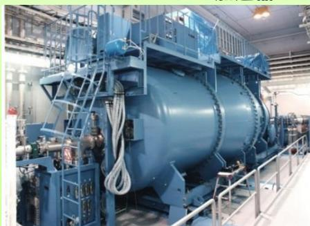
水素イオン、炭素イオンをシンクロトロンで加速できる速度まで加速します。(水素イオンの場合、最大で光速の約14%)
