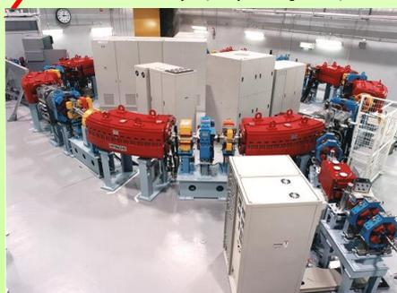
水素イオン、炭素イオンを品種改良に適した速度まで加速します。(水素イオンの場合、最大で光速の約60%)
