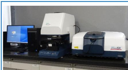
赤外分光光度計 (FT/IR-6X)、顕微鏡ユニット (IRT-5200)
