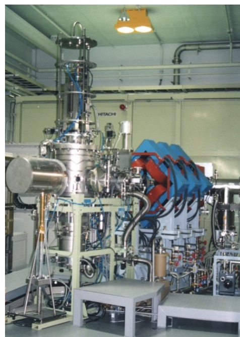
(写真)試験に使用したマイクロ波イオン源イオン注入装置(エネ研にある3種類の加速器のひとつ)
