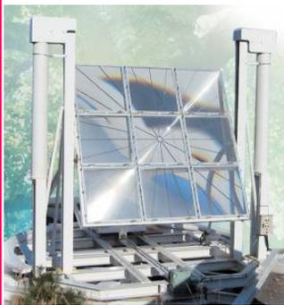
3000以上のクリーンな超高温を作り出す10kW級大型太陽炉
