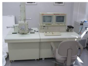
低真空走査型電子顕微鏡
