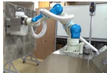
レーザー除染装置（試作機）
