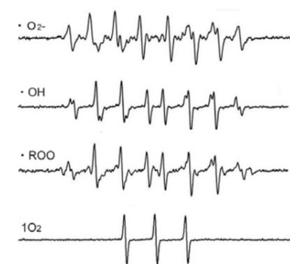
電子スピン共鳴装置の測定スペクトル
