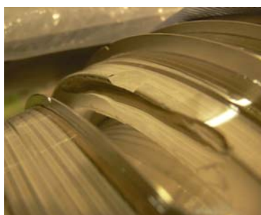
（写真2）加速管接着部
