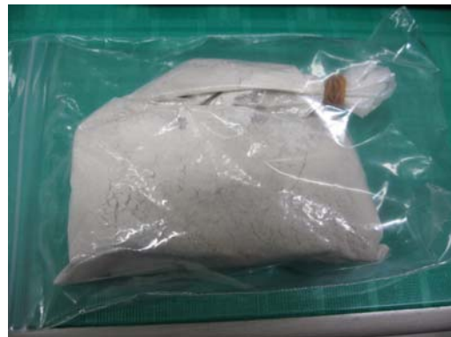
分離除去された粉末状アルカリ金属塩化物
