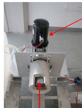
黒っぽいのが加熱部 SiC 製カバー (集光部以外は、更に耐火断熱繊維とステンレス製カバーで覆ってある)
