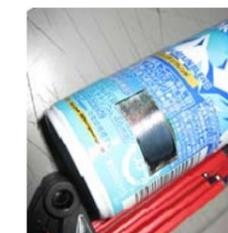
コーヒー缶の側面の曲面をレーザー除染した写真
