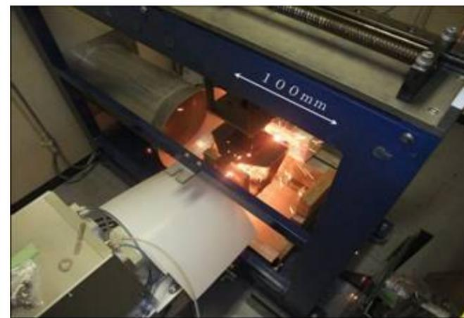
原子力機構・レーザックス、若狭湾エネ研の共同研究体制の下、実施した厚板切断試験。レーザー照射時の写真(若狭エネ研で実施)
