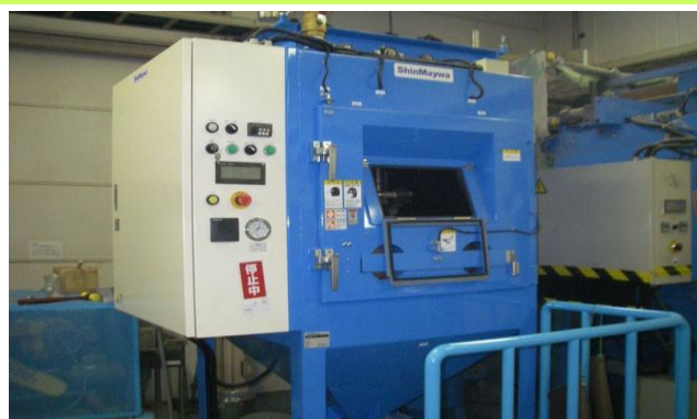
固定型サンドブラスト除染装置から「密閉式固定型レーザー除染装置」への置き換えを検討中
