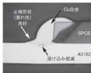
アルミニウムと鉄鋼材料の異種材料接合
