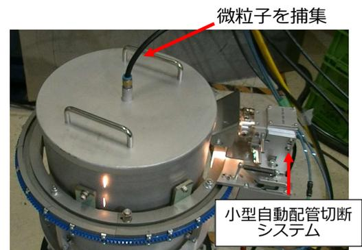
切断時に微粒子を捕集して分析している様子
