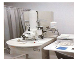
走査型電子顕微鏡 (日本電子製 JSM-6340F)
