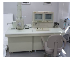
低真空走査型 電子顕微鏡 (日本電子製 JSM-4310)
