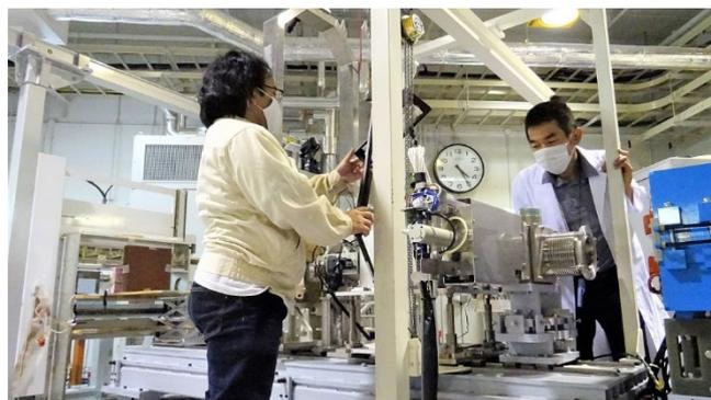
試験実施風景：本試験では、超小型人工衛星搭載等を目指した電子デバイスに陽子線を照射し、影響を評価します。
