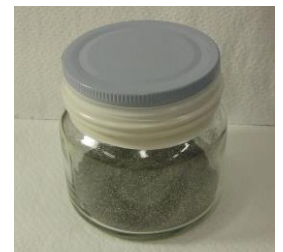
ニッケルを加えて粉砕処理したマグネシウム粉末
