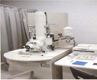
走査型電子顕微鏡装置
