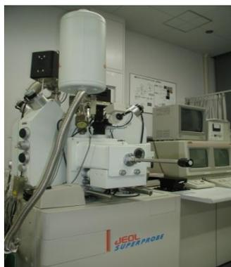
③EPMA（電子プローブマイクロアナライザー装置）
