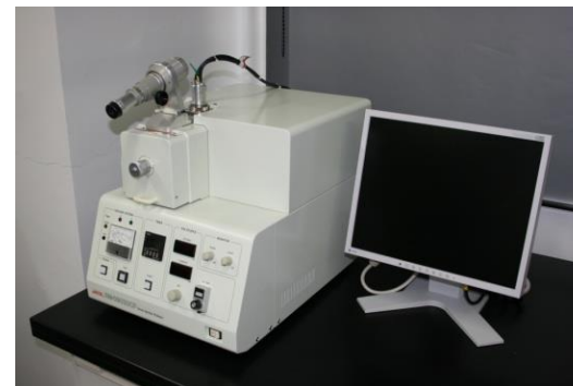
②試料前処理研修 (クロスセクション® リッシャー使用) 日本電子 SM-09020CP
