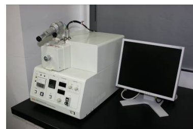
⑥試料前処理研修 (クロス・セクション・ポリッシャー使用) 日本電子 SM-09020CP
