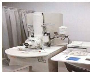
①FE-SEM (走査型電子顕微鏡) 日本電子 JSM-6340F
