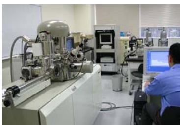
⑤XPS (高分子結合状態解析システム) 日本電子 JPS-9010MC
