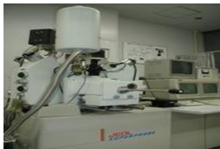
②EPMA (電子プローブマイクロアナライザ装置) 日本電子 JXA-8900RL
