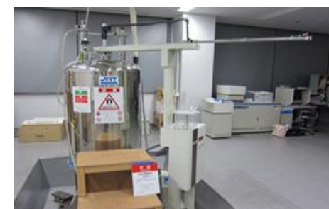
⑦FT-NMR (フーリエ変換核磁気共鳴装置) 日本電子 JNM-ECP600
