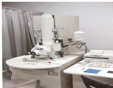
①FE-SEM (走査型電子顕微鏡) 日本電子 JSM-6340F
