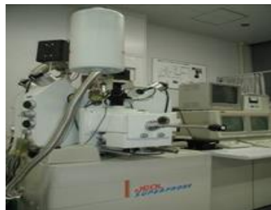
②EPMA (電子プローブマイクロアナライザ装置) 日本電子 JXA-8900RL
