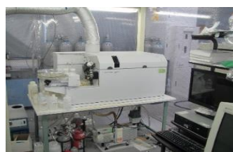
⑥ICP-MS (誘導結合高周波プラズマ質量分析装置) アジレントテクノロジー Agilent7500CX
