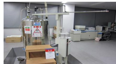
⑦FT-NMR (フーリエ変換核磁気共鳴装置) 日本電子 JNM-ECP600
