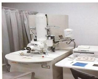
①・⑥FE-SEM (走査型電子顕微鏡)
