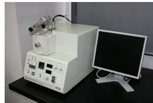
③試料前処理研修 (クロスセクションポリッシャー使用) 日本電子 SM-09020CP
