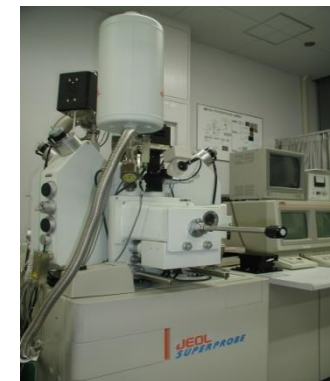
③EPMA (電子プローブマイクロアナライザー装置) 日本電子 JXA-8900RL
