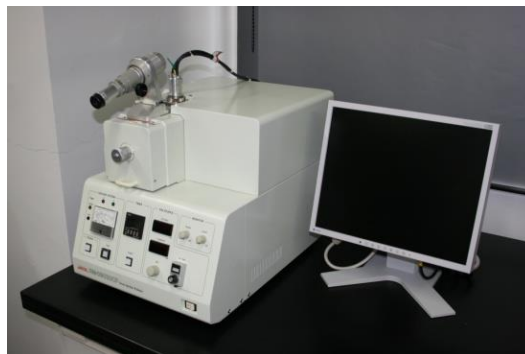
②試料前処理研修 (クロスセクションポリッシャー使用) 日本電子 SM-09020CP
