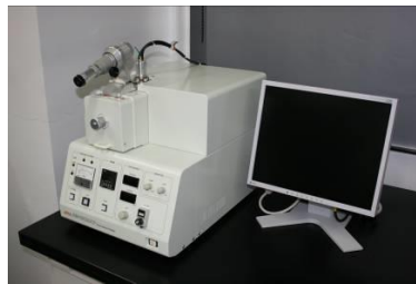
②試料前処理装置 (クロスセクションポリッシャー使用) 日本電子 SM-09020CP
