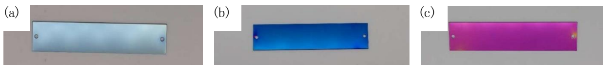
図2 (a)Ar 400 sccm、H 2 80 sccm、カソード出力 300 W で 60 分間成膜されたステンレス板、(b)Ar 260 sccm、H 2 320 sccm、カソード出力 500 W で 26 分間成膜されたステンレス板、(c) Ar 460 sccm、H 2 320 sccm、カソード出力 500 W で 80 分間成膜されたステンレス板。板の大きさはすべて 18 mm×80 mm×0.5 mm である。
