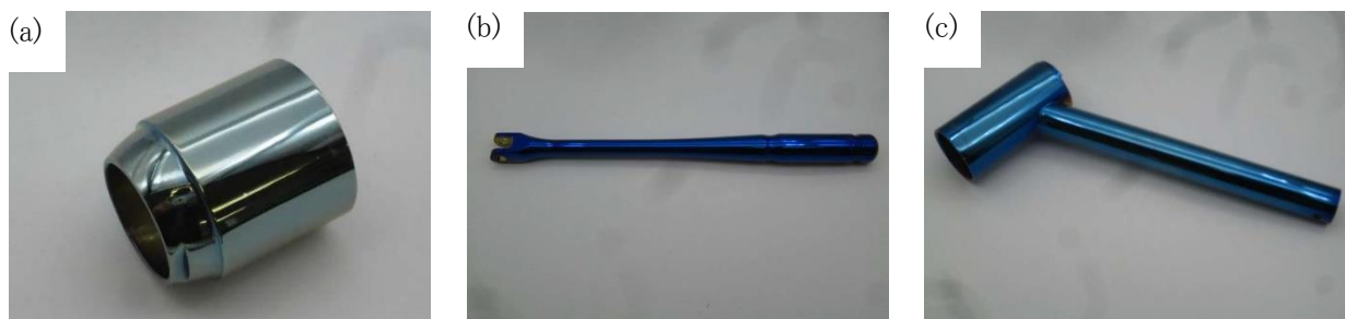
図3 (a)Ar 430 sccm、カソード出力 500 W で 42 分間成膜された水栓部品(直径 44 mm)、(b)Ar 260 sccm、H 2 320 sccm、カソード出力 500 W で 26 分間成膜されたラチェットレンチハンドル(長さ 285 mm)、(c) Ar 260 sccm、H 2 320 sccm、カソード出力 500 W で 55 分間成膜された大型水栓(長さ 270 mm)
