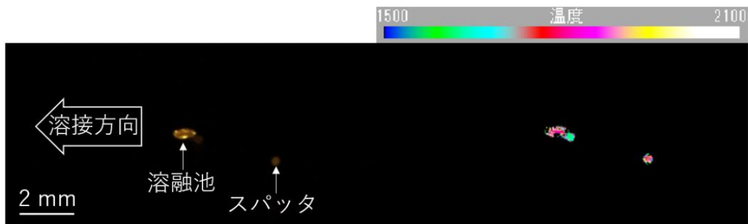
図4 2色式画像温度測定によるレーザー溶接中の様子
