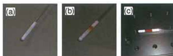
図-3 バナジウム酸化物担持非晶質シリカ感湿材料の動作: (a) 乾燥状態 (b) 吸湿中 (c) 吸湿後
